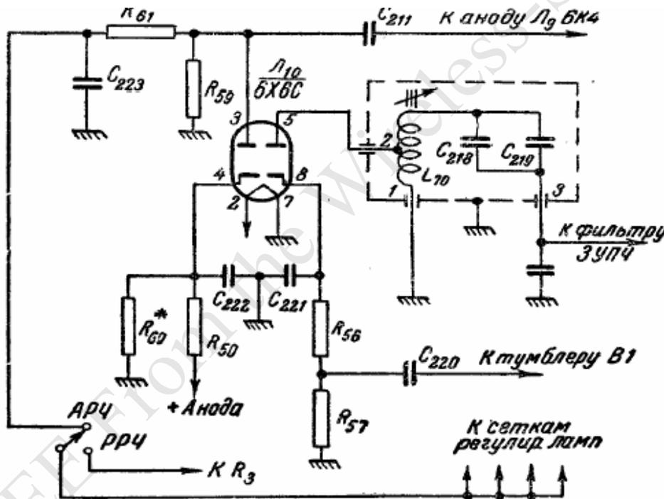
Рис. 9. Детектор сигнала и детектор АРС.
